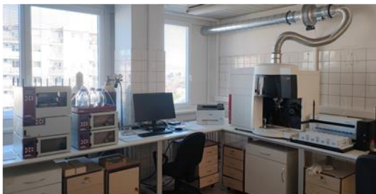
Ionový chromatograf na priame stanovenie iónov a ICP-OES na stanovenie ťažkých kovov
