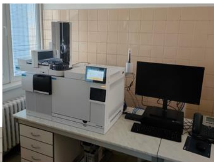
Zariadenie na skríningovú (HPLC-FLD) a konfirmačnú (HPLC-FLD/DAD) analýzu mykotoxínov
